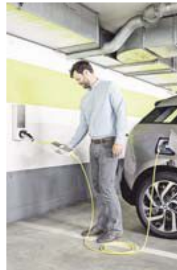
Ladesystem von Ubitricity: Der Stromzähler steckt im Kabel.
