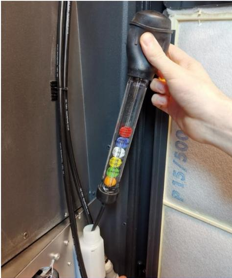
**Abbildung 108:** Überprüfung der Konzentration mit einem Refraktometer
