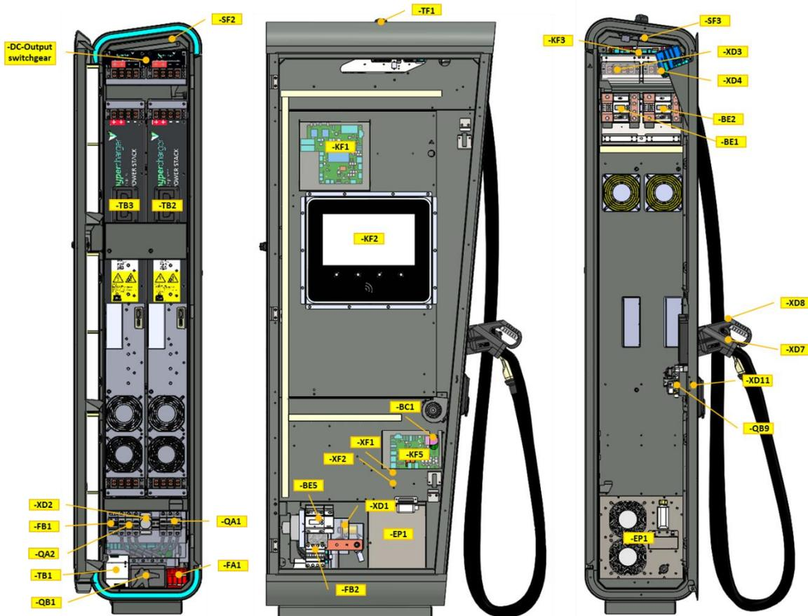
**Abbildung 13:** Innenansicht hypercharger HYC\_150 (Service-, Display-, Ladekabelseite)
