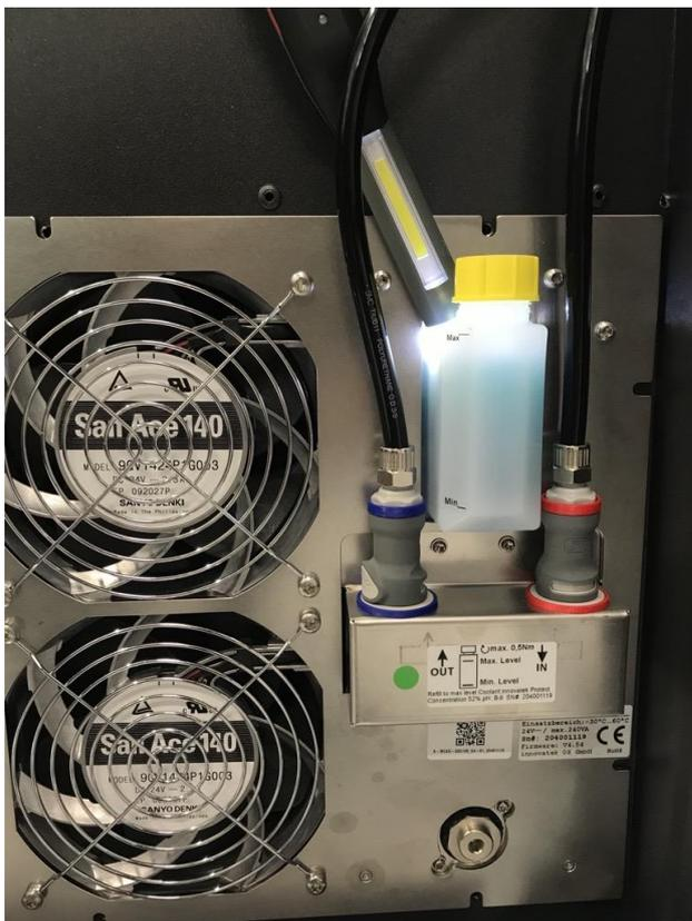
Abbildung 107: Überprüfung des Füllstandes des Kühlers
