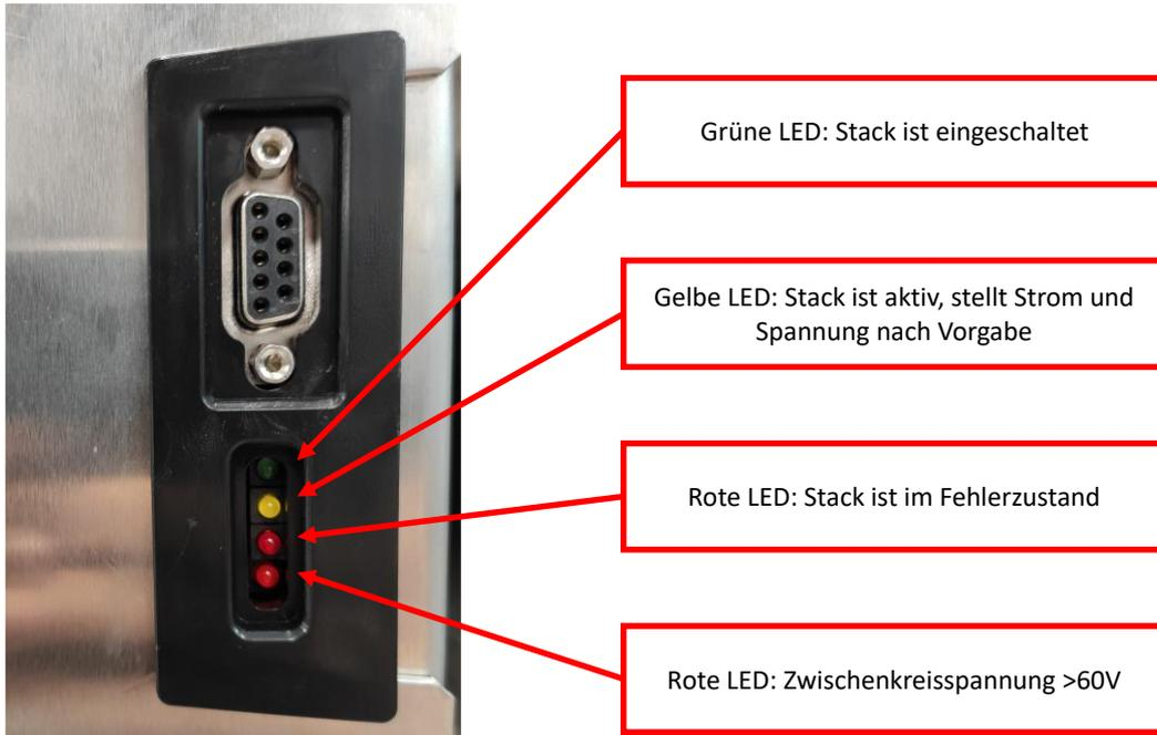
**Abbildung 18:** Statusanzeige Power-Stack
