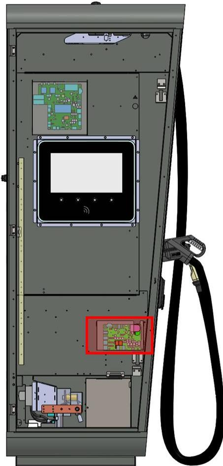
Abbildung 29: Position der CTRL\_EXT im hypercharger
