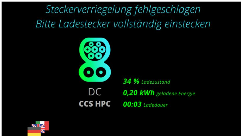
Abbildung 73: Steckerverriegelung fehlgeschlagen
