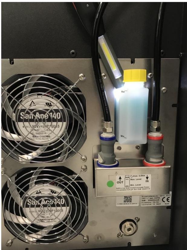
Abbildung 83: Überprüfung des Füllstandes des Kühlers
