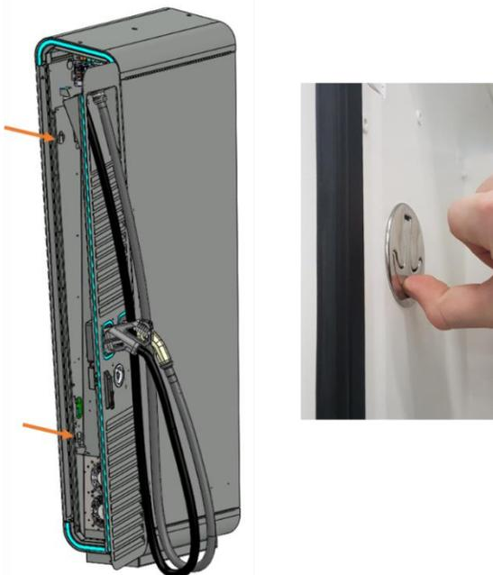
**Abbildung 12:** Verriegelungsmechanismus für die Displaytür
