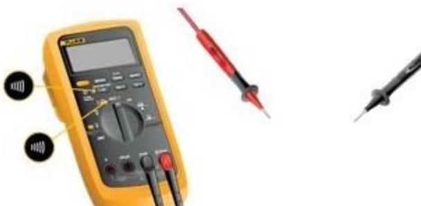
Abbildung 79: Digitales Multimeter
