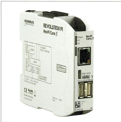
Die zentrale Steuereinheit des Lade- und Energiemanagementsystems von The Mobility House ist kaum größer als ein Kartenspiel. Der sogenannte Smart Charging Controller (SCC) wird im Sicherungskasten integriert und regelt die lokalen Ladevorgänge.
