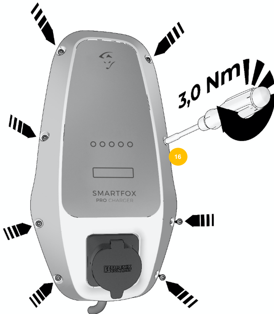
Abbildung 19 Deckelmontage
